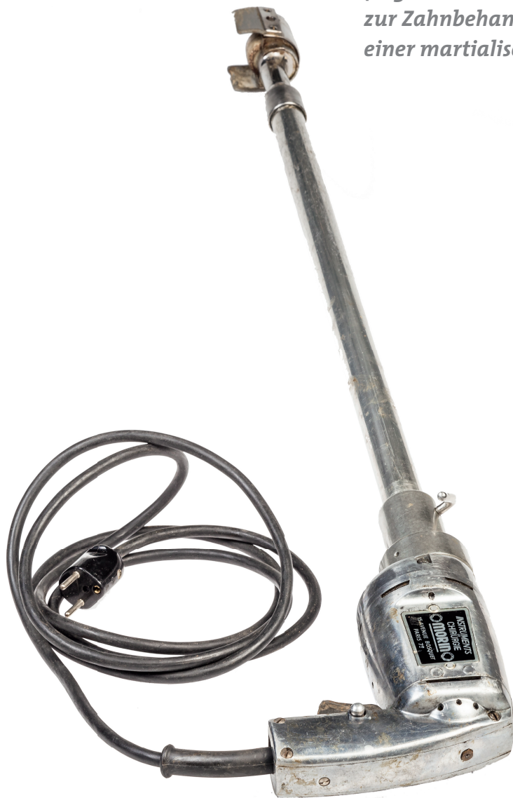
Zahnschleifapparat für Pferde nach Becker (um 1960), zur schonenden Zahnbehandlung.
