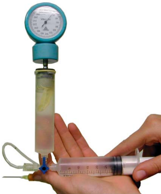
Abbildung 1 : Das aneroides Messsystem.
