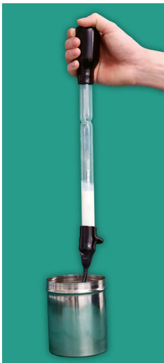
Abbildung 1: Kolostrometer der Firma Kerbl in Buchbach zur Messung des spezifischen Gewichtes von Rinderkolostrum mit Skala für den IgG-Gehalt.
