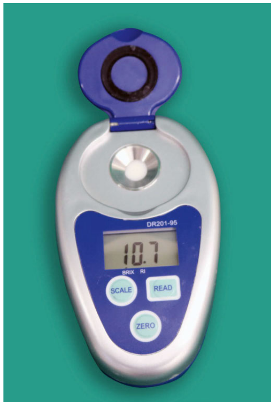
Abbildung 2: Brix-Refraktometer DR201-95 der Firma Krüss in Hamburg zur Messung der spezifischen Dichte in Grad-Brix.
