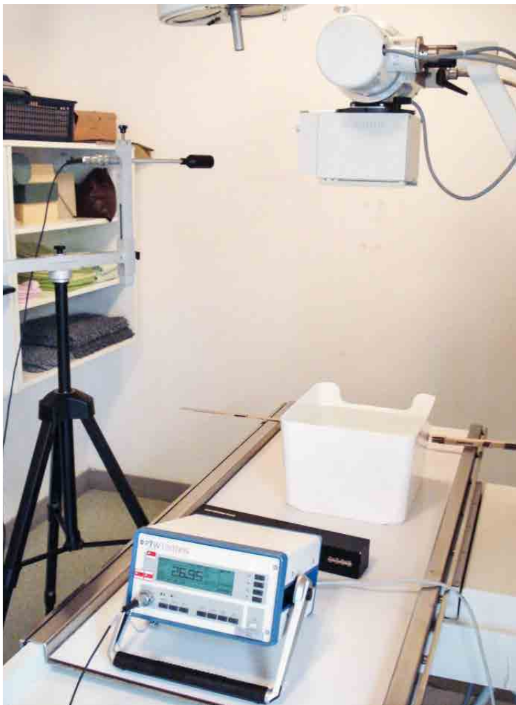
Abbildung 1: Messanordnung mit Röntgenanlage, Wasserphantom, Stativ mit Ionisationskammer und Elektrometer.
